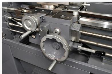
過負荷保護機構: 送りロッドとハンドホイールには調整可能な「安全過負荷スリップクラッチ」を装備しており、過度な負荷による機械や工具の破損を防ぎます。
