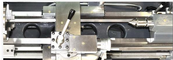
高剛性ベッド構造: ベッドには高張力鋳鉄を採用。焼入れおよび研磨仕上げが施されており、振動を抑えた高精度な加工を長期にわたり維持します。
