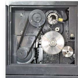
精密仕上げの主軸: ヘッドストック内のギアは焼入れ・研磨済み。主軸は2つの精密テーパーローラーベアリングで支持されており、主軸貫通穴径は40mm (1-9/16インチ) を確保しています。
