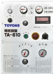
集中操作パネル: すべての操作ノブをヘッドストック前面に配置。作業者が直感的に操作でき、作業効率を高めるレイアウトを採用しています。
